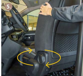
Pour pivoter le siège conducteur, il faut d'abord desserrer le frein à main.
