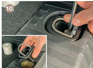
Serrez les anneaux d'attache avec une clé Torx (taille T 40).
