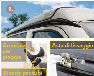
Con il Multirail, è possibile fissare facilmente le tende da sole e i parasole con un'asta a morsetto o con una tubazione a strappo.
