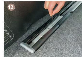
Desserrez et retirez la vis de la liaison du rail avec une clé allen (4 mm).
