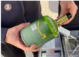
Gasleitung an der Gaskartusche
