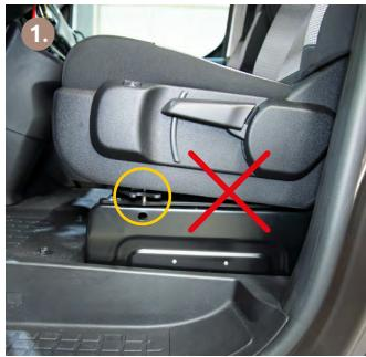
**IMPORTANT!** Les sièges doivent nécessairement être placés vers le haut.
