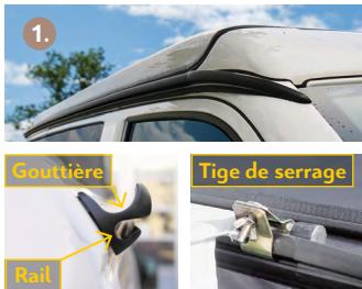
Le Multirail permet de fixer voiles d'ombrage et auvents avec une tige de serrage ou un profilé en bourrelet.
