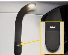
Nel veicolo è disponibile una lampada da lettura a LED mobile con connessione USB integrata nella parte posteriore sinistra e destra. Una terza si trova nel tetto sollevabile.
