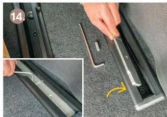
Auf der rechten Seite die Schienenanbindung ebenfalls lösen, leicht nach rechts drehen und aus der Schiene nehmen.
