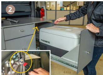
Kühlbox aus der Schublade entfernen (zuerst unbedingt den 12V Stecker in der Soulboxx rausziehen).
