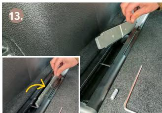
Auf der linken Seite die Schienenanbindung nach hinten schieben, leicht nach rechts drehen und aus der Schiene nehmen.
