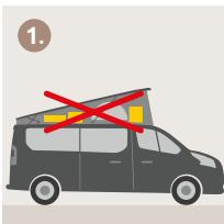
**ATTENTION!** Il ne doit y avoir aucun objet dans le toit relevable !
