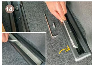
Desserrez la connexion du rail sur le côté droit, tournez-la légèrement vers la droite et retirez-la du rail.
