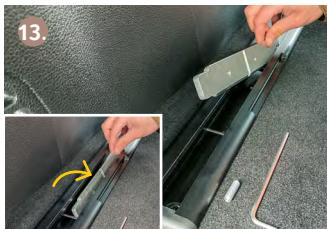
Sur le côté gauche, poussez la liaison du rail vers l'arrière, tournez-la légèrement vers la droite et retirez-la du rail.
