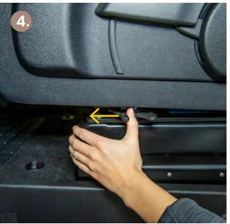
Tirez la languette de verrouillage et pivotez les sièges.
