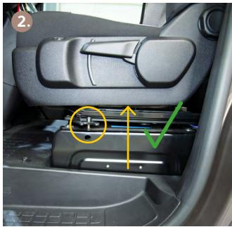
De sorte qu'en les pivotant, le revêtement des sièges ne soit pas endommagé.
