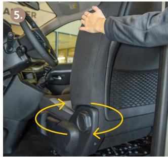
Rilasciare il freno a mano per girare il sedile del conducente.
