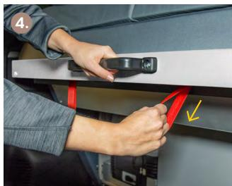
Tirare uno dei nastri rossi sotto il telaio del letto per rilasciare il blocco del telaio del letto.
