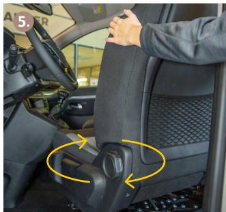
Um den Fahrersitz zu drehen, muss die Handbremse zuerst gelöst werden.
