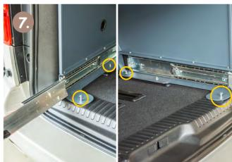
Die gelb markierten Schrauben mit einem 13 mm Gabelschlüssel lösen und herausnehmen. Beim Fahrzeug XL 17 mm Gabelschlüssel verwenden.
