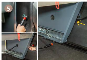
**IMPORTANT!** Débranchez d'abord l'alimentation électrique ! La prise est accessible par la trappe latérale gauche.
