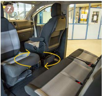
Il sedile del conducente e del passeggero può essere ruotato.
