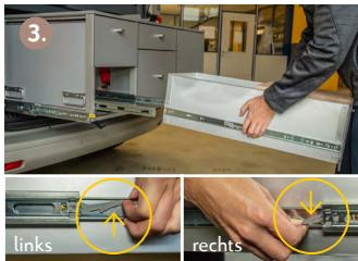
Linke Schublade unten entfernen. Hebel an der linken Schiene nach oben, an der rechten Schiene nach unten drücken.
