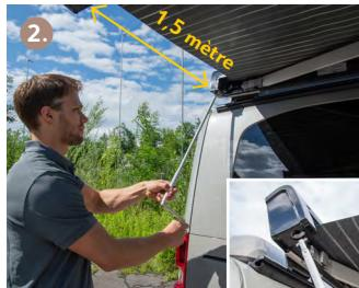
Déployer l'auvent jusqu'à 1,5 mètre à l'aide de la manivelle.
