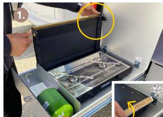
Ouvrez le couvercle en aluminium et le couvercle de la rechaud à gaz.
