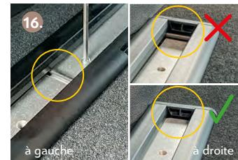
**IMPORTANT !** Lors du démontage, veillez à ce que les liaisons de rail soient correctement positionnées.
