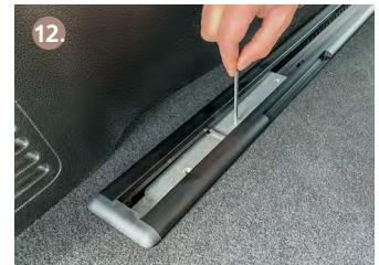
Die Schraube der Schienenanbindung mit einem Inbusschlüssel (4 mm) lösen und entfernen.
