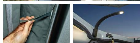
**ASTUCE:** Le toit peut être ouvert complètement grâce à des fermetures éclair. Le soufflet en tissu peut être enroulé et fixé à l'aide des trois fermetures velcro. Une liseuse à LED pratique se trouve dans le toit relevable.
