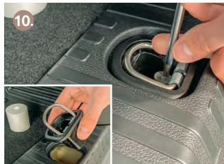
Die Binderringe mit einem Torx-Schlüssel (Grösse T 40) festschrauben.
